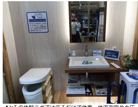
▲IoTの体験ラボでは座るだけで体重・体温測定や血圧、尿分析などを測れるインテリジェントトイレを設置
