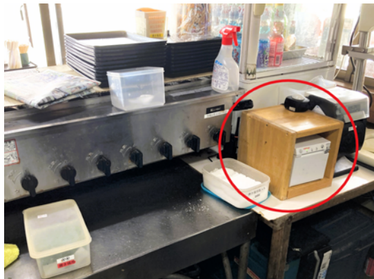
▲注文情報は自動的にキッチンプリンターに送られる(右側箱の中)
